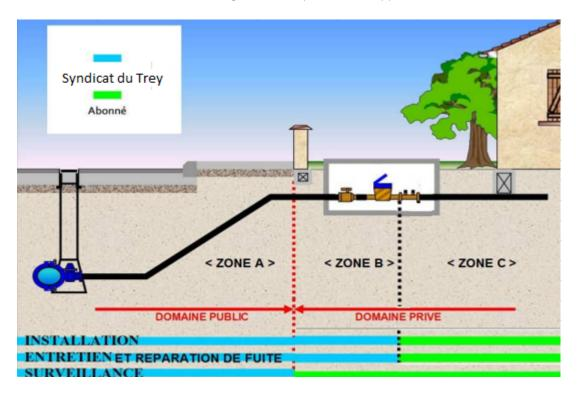
Le branchement est propriété du syndicat jusqu'à la sortie du compteur sans le joint. L'abonné est responsable de la surveillance du compteur, du regard qui l'accueille et du clapet anti-retour placé après compteur conformément aux prescriptions particulières de l'annexe B.
